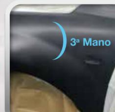
Aggiungere nuovamente il 25-30% di 1.550.0010 (diluente al 30%), ed applicare una mano leggera ai bordi della precedente, allargandosi di circa 10 cm. Applicare una mano di sfumatura. A completo appassimento procedere con l'applicazione del trasparente.
