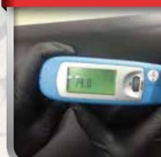
Per colori opachi originali il grado di opacità è abbinato alla formula colore disponibile in PaintManager®. Se non si conosce il grado di opacità, misurare con glossmetro o procedere con l'applicazione delle "fasce TO01/TO05" su lamierini provatinta, applicati con il colore scelto.
