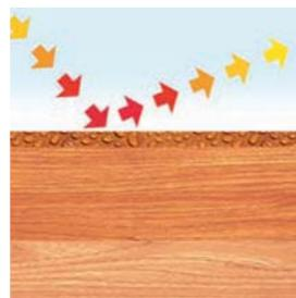
*La finitura forma una sottile pellicola idrorepellente e resistente ai raggi UV.*
